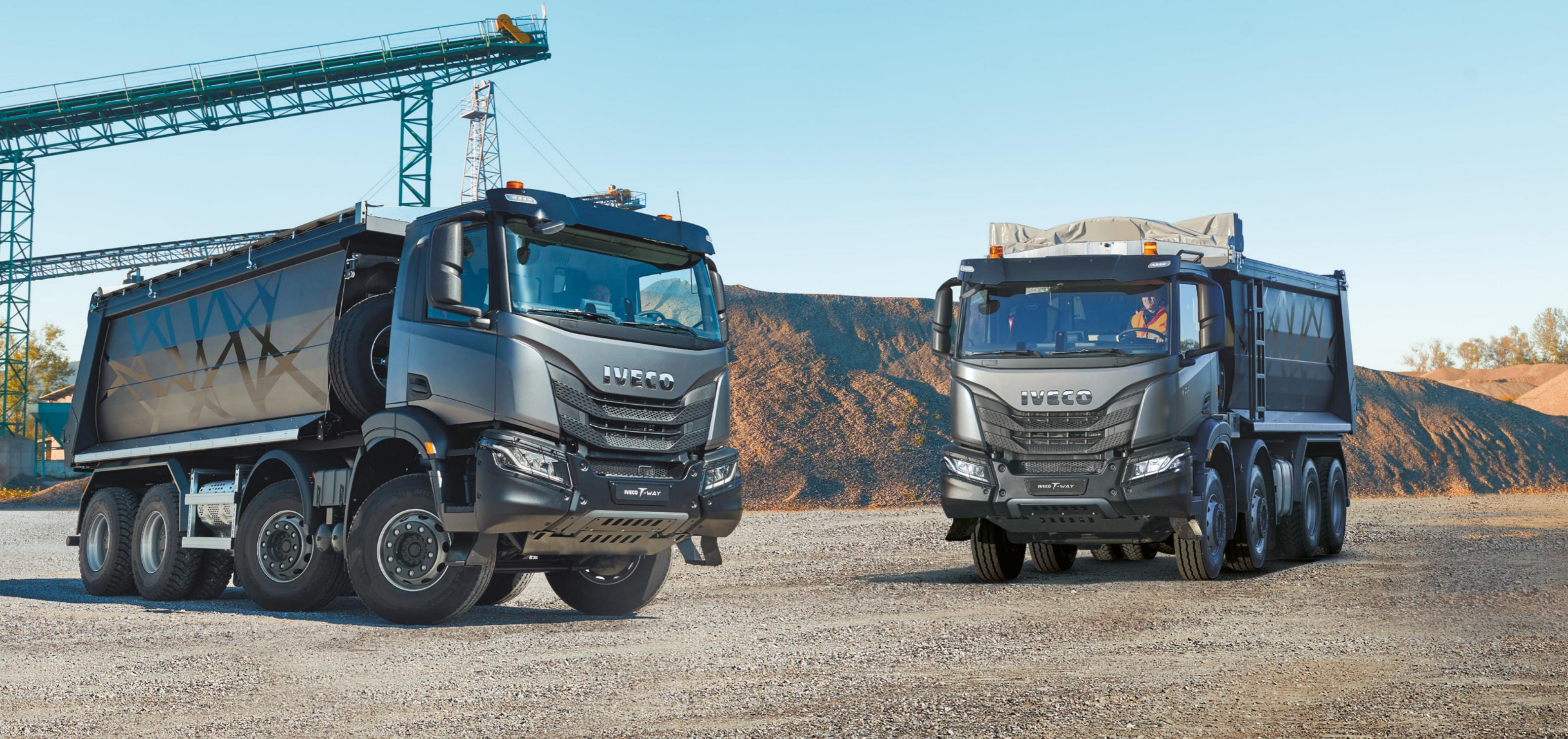
IVECO T-WAY je konstruiran i izrađen tako da jamči pouzdanost i trajnost suočen s najtežim izazovima i preprekama. Legendarna robusnost šasije od čelika visoke čvrstoće, s debljinom stijenke od 10 mm, u kombinaciji s velikom otpornošću ovjesa, pridonose odličnim performansama u najtežim uvjetima.
